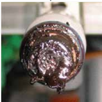
Contaminarea injectoarelor (injectoare)
