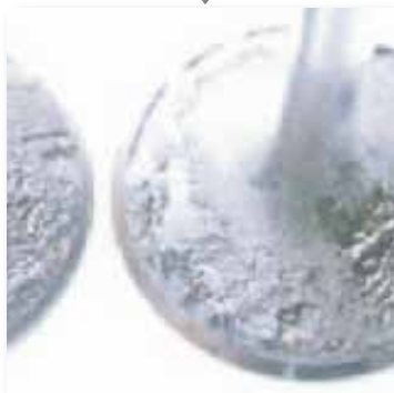
Depuneri de carbon pe supape
