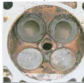
Depuneri și coroziune pe supape
